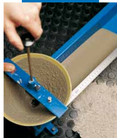
Badanie płynności po wymieszaniu zgodnie z EN 13395-2
