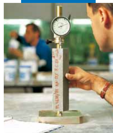
Badanie skurczu w fazie twardnienia zgodnie z normą UNI 8147
